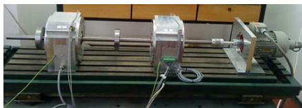
Fig. 2. Experimental test rig (from left to right): disk 1, radial AMB A, disk 2, radial AMB B, flexible coupling and electromotor
